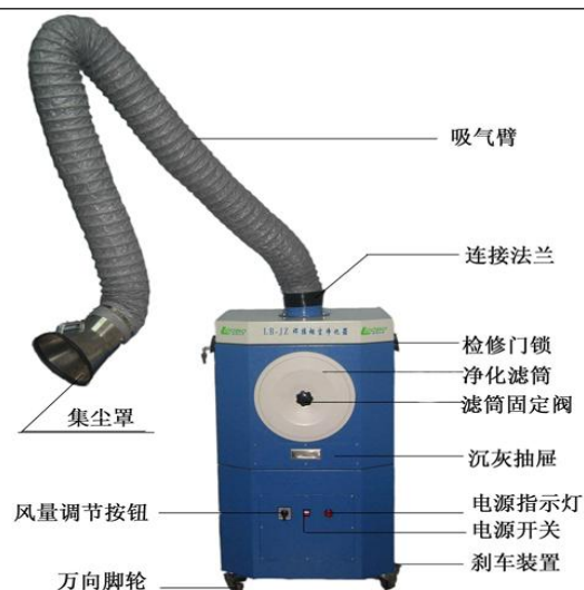
图 4-2 移动式烟尘净化器结构示意图
