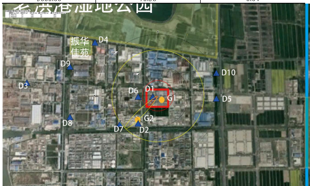
图 5.2.8-1 TDI 蒸发最大影响区域图（最不利气象）
