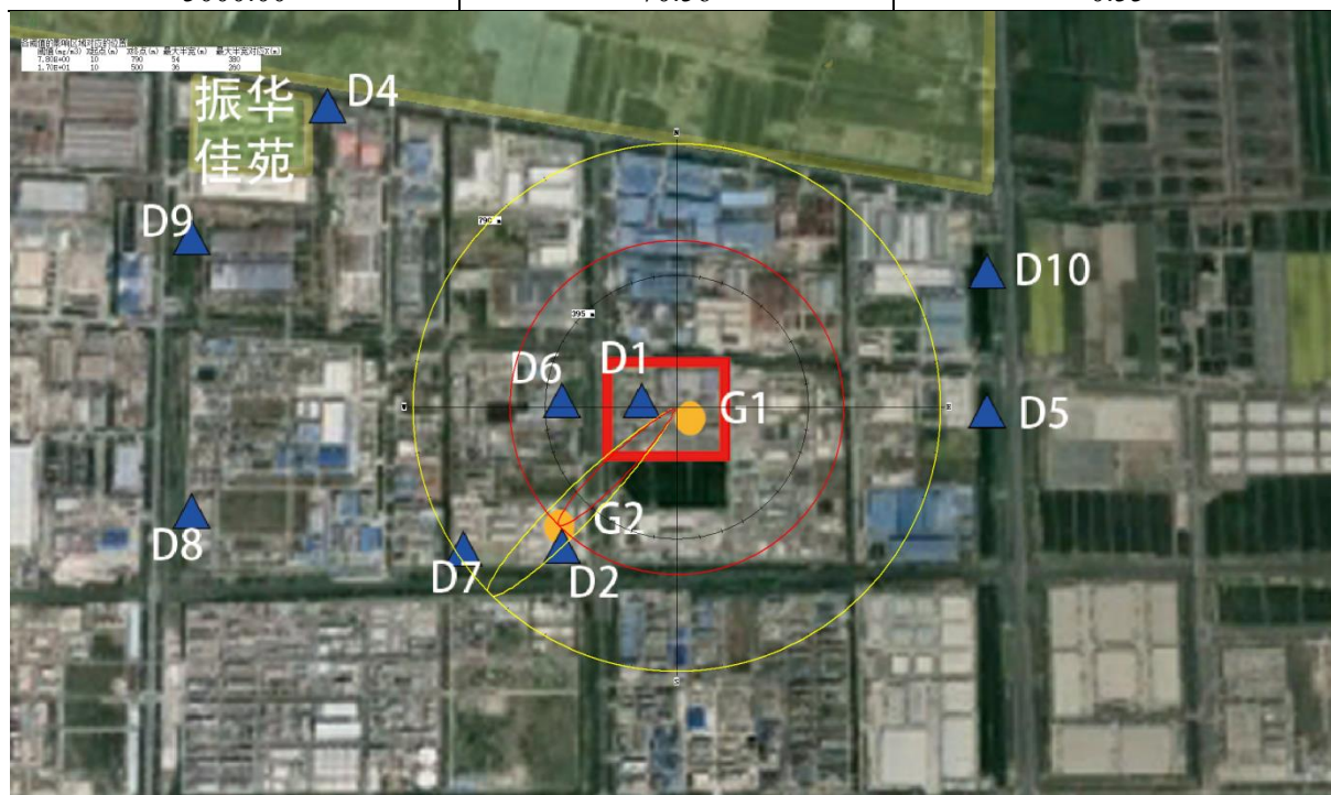
图 5.2.8-7 氰化氢扩散最大影响区域图（最不利气象）
